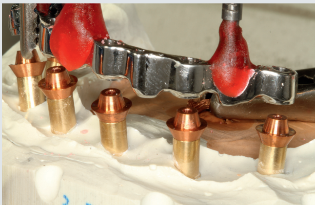
Der SAE-Funkenerosionsprozess mit Elektroden
