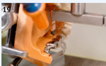
Der Funkenerosionsprozess ist nach Erreichen der Solltiefe beendet, Erosionsdauer ca. 20 Minuten (CrCoMo).
