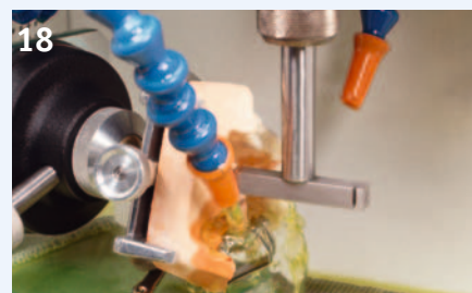
Der Funkenerosionsprozess ist gestartet unter Spülung des Dielektrikums.
