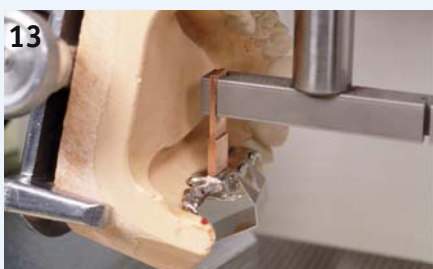
Positionierung des Modells mit dem Primär-Sekundärteil. Durch Anfahren der abgelängten Elektrode wird die Erosionsposition festgelegt.
