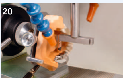
Der Funkenerosionsprozess ist nach Erreichen der Solltiefe beendet, Erosionsdauer ca. 20 Minuten (CrCoMo).
