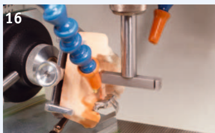
Der Dielektrikumschlauch ist in Position gebracht.
