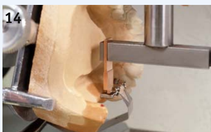
Mit der Elektrode (Bestell-Nr. 30-1384) wird die Erosionstiefe am Zapfen des Primärteils eingestellt. Die Kralle dient zur Festsetzung des Primärteils.
