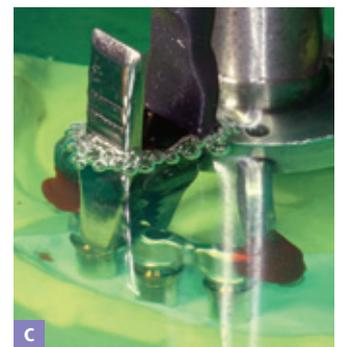
Abb. 40 a Nachdem die elektrischen Kontaktklammern (– am Modell und + an der Struktur) angelegt sind, ist der Stromkreis geschlossen; b der Funkenerosionsprozess wird gestartet; c das Dielektrikum wird durch den orangenen Kanal an die Struktur direkt herangeführt und das Modell mit dem Erosionsobjekt im Dielektrikum durch Fluten der Wanne voll eingetaucht.
