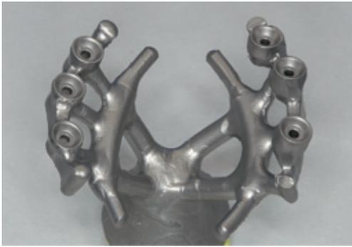
Abb. 36 Der Guss aus der Co-CrMo-Legierung SAE Okta-C.
