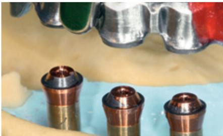
Abb. 41 Nach dem ersten Funkenerosionsprozess, der max. zehn Minuten dauert, ist die Struktur zirkular voll aufsitzend. Die Elektroden sind teilweise abgebrannt und müssen für die folgende Feinsterosion ausgewechselt werden.
