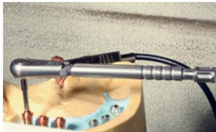
Abb. 42 Die abgebrannten Elektroden werden gegen neue Elektroden für den zweiten Funkenerosionsprozess ausgetauscht und mit dem Drehmomentschlüssel angeschraubt.
