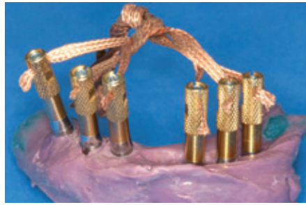
Abb. 26a und b An jede Modellhülse wird die Kupferlitze zur Herstellung der stromführenden Kontaktleitung für den späteren Funkenerosionsprozess angeschraubt, der zur Passivierung der Mesostruktur dient.
