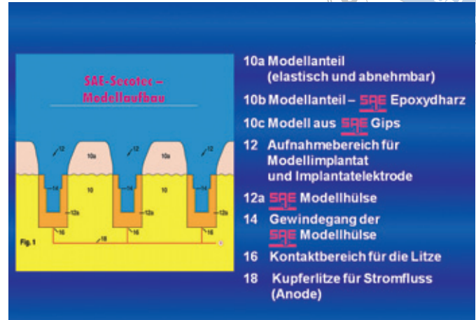
Abb. 24 Der Aufbau des formstabilen SAE-Funkenerosionsmodells.
