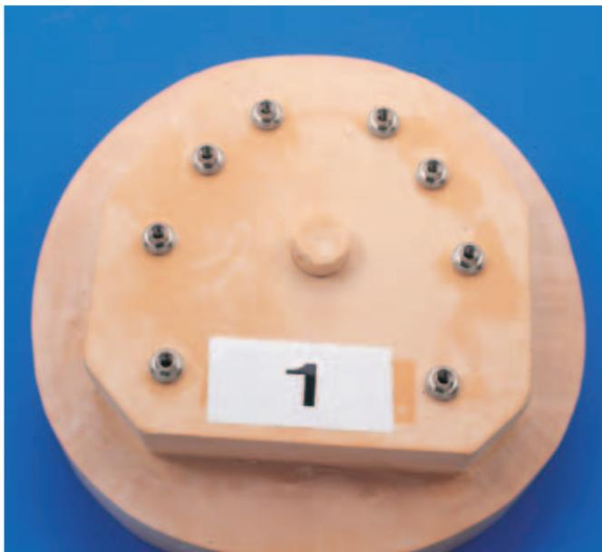
Abb. 10 Modell-Test 1: Naturgips resinverstärkt, Firma A.
