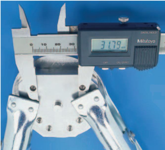
Abb. 7 Die elektronische Schieblehre mit den zwei erodierten Messpassungen auf dem Testmodell 0 angelegt.
