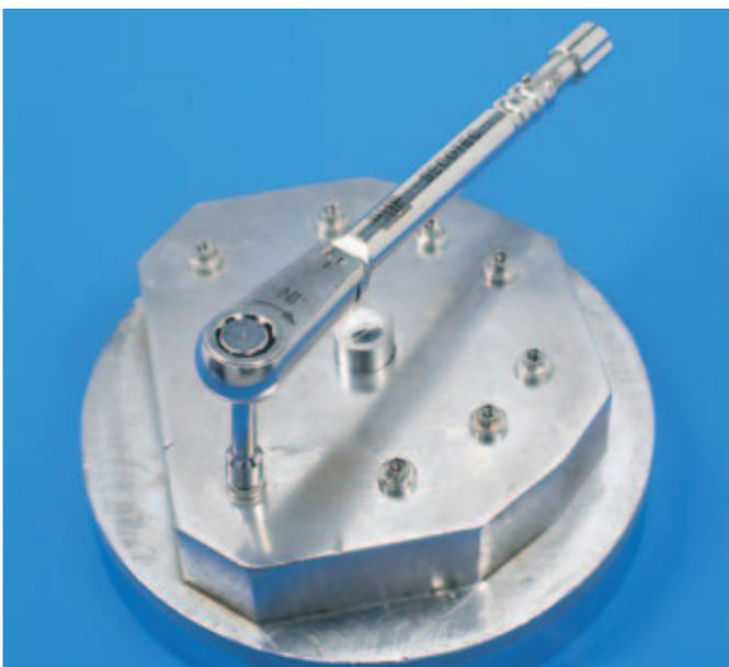
Abb. 1 Mit dem Drehmomentschlüssel wurden die Modellimplantate mit Anzugswert 15 Ncm im Stahlmodell festgeschraubt.
