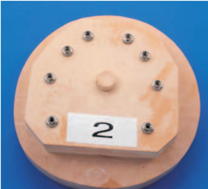
Abb. 11 Modell-Test 2: Naturgips resinverstärkt, Firma B.
