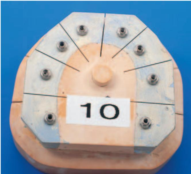
Abb. 19 Modell-Test 10: Epoxydharz in Sektionen und Naturgips resinverstärkt, Firma A.
