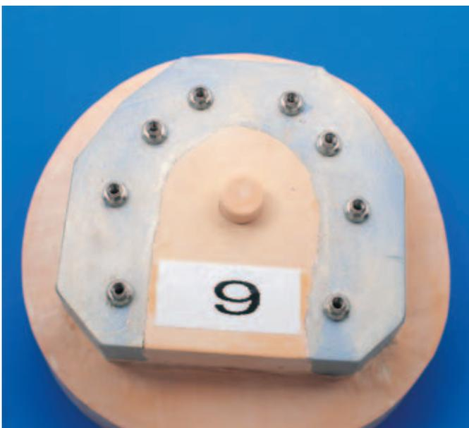
Abb. 18 Modell-Test 9: Epoxydharz und Naturgips resinverstärkt, Firma A.
