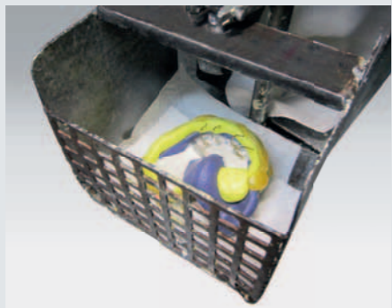
5] Слепок поместить в горизонтальную центрифугу с противовесом. Процесс вращения: 1 минута
