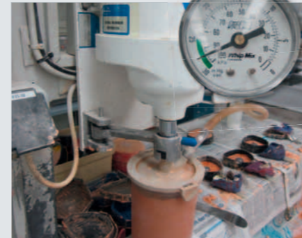
9] Замешанный в вакуумном миксере SAE специ гипс – 1 минута при 15-20 миллибарах.
