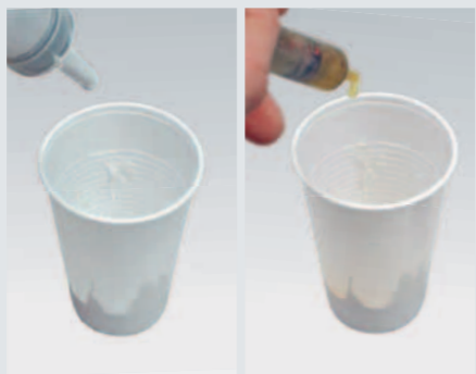
2] Дозировка: эпоксидная смола: 6 частей (мл) эпоксидный отвердитель: 1 часть (мл) ...
