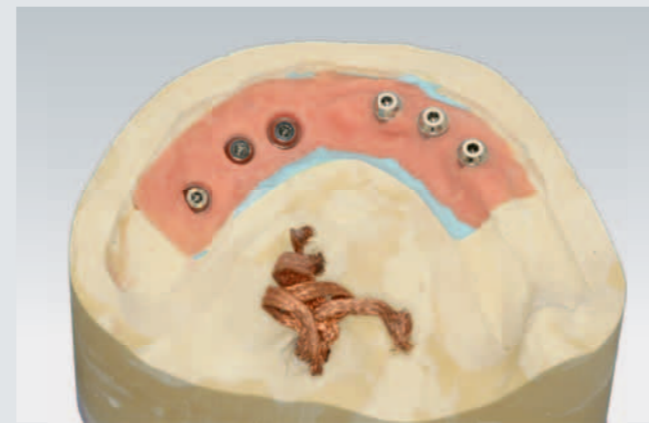
11] Формостабильная SAE-мастер-модель с вывинчивающимися SAE-модельными имплантатами, заменяющимися для процесса искровой эрозии на годные для эродирования медные электроды.
