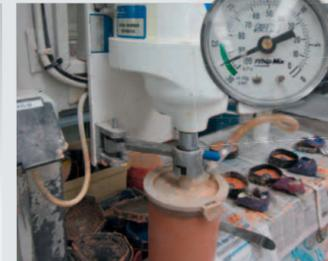
9] Der angerührte SAE Spezi Gips im Vakuummischer – 1 Minute bei 15-20 Millibar.
