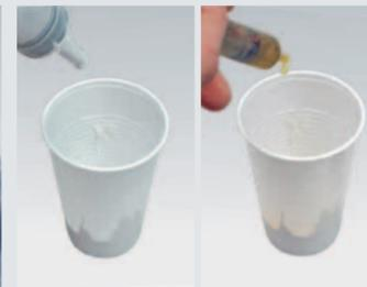
2] Dosierung: Epoxyharz: 6 Teile (ml) Epoxyhärter: 1 Teil (ml) ...
