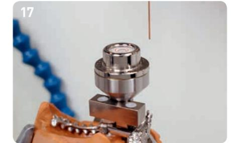
17 Für die Erosion der Riegelachse im 90°-Winkel zur erodierten Riegelpassung wird das Riegelteil (Best.-Nr. 30-1242) in die Riegelpassung eingesteckt und daran die Achsführung (Best.-Nr. 30-1602) montiert. Die in die Riegelaufnahme gesteckte Libelle (Best.-Nr. 82-1201) dient zur Ausrichtung der Parallelität.
