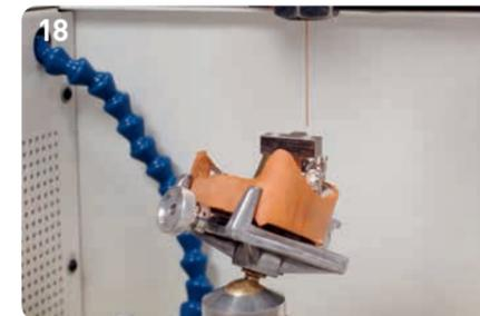
18 Zur exakten Zwangsführung wurde die Elektrode (Best.-Nr. 30-1004) in die Teflonbuchse der Elektrodenführung eingefahren. Buchse passend für eine 0,8 mm-Elektrode.
