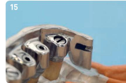
15 Die im Primär- und Sekundärteil fluchtende Riegelpassung.
