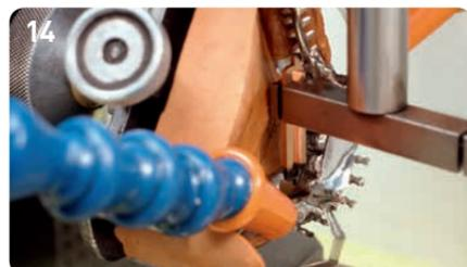
14 Die abgebrannte Elektrode nach Beendigung des Erosionsprozesses.
