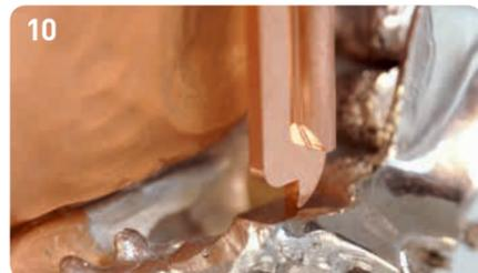
10 Die Klammer fixiert das Sekundärteil auf dem Primärteil und stellt zudem den elektrischen Kontakt her. Die Elektrode mit langsamem Vorschub auf den Modellguss aufsetzen lassen (Piepton), und die Tiefeneinstellung am Display vornehmen (Tiefe: 5,5 – 5,7 mm).
