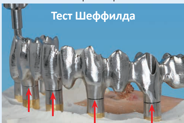
Перед пассивацией посредством САЕ-искровой эрозии
