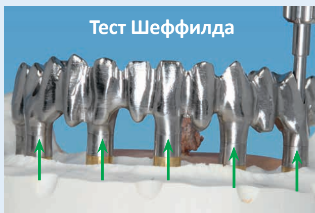
После пассивации посредством САЕ-искровой эрозии
