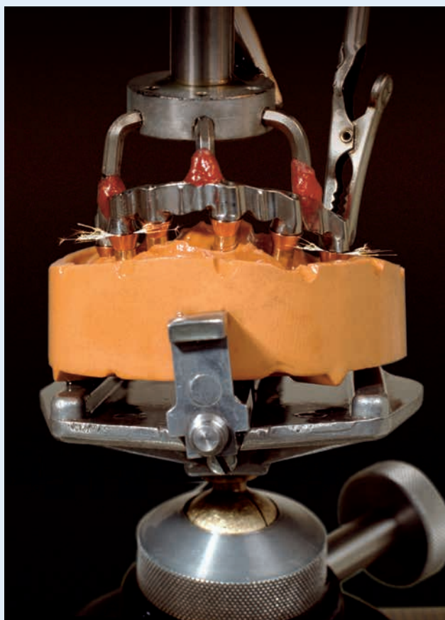
САЕ-искровая эрозия для пассивации имплантатных структур на абатментах с стандартизированным поверхностным дизайном
