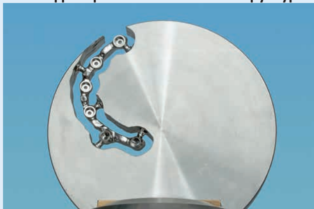
17. Фрезеровальная заготовка с отфрезерованной балочной структурой
