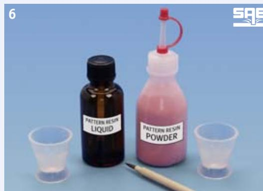
6 Das Pulver / Liquid-Verfahren mit dem Pattern Resin eignet sich hervorragend zur Verbindung der Segmente.
