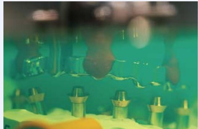
Der Funkerosionsprozess im Dielektrikum in der SAE-Funkerosionsmaschine
