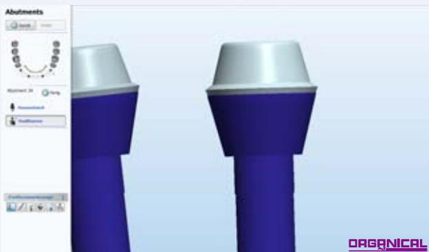
Die Schulter des Stegaufbaus wird an das Abutment angeglichen
