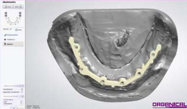
Stegaufbauten sind konstruiert auf den Ankylos-Abutments
