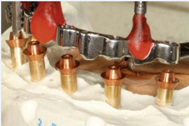
Die Montage der Stegstruktur in der Maschine. Modellimplantate werden gegen erodierfähige Elektroden ausgetauscht, **Anzugsdruck = 20 Ncm**
